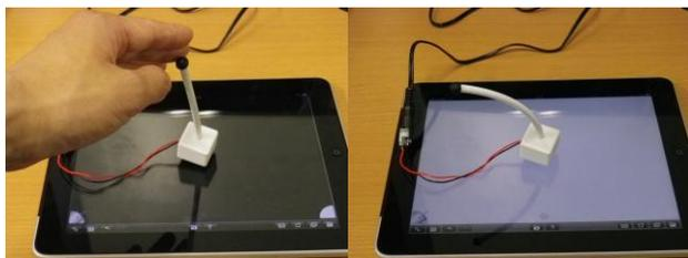
図 5 導電体を通じた接触判定の様子
