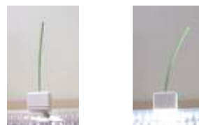
図 3 Hairlytop Interface の光による屈曲の様子
